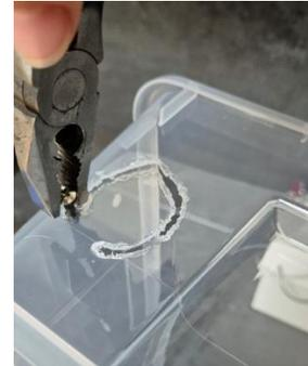
5. Fädle nun das Drahtseil durch die gebrannten Löcher, so dass Box und Deckel miteinander verbunden werden.
